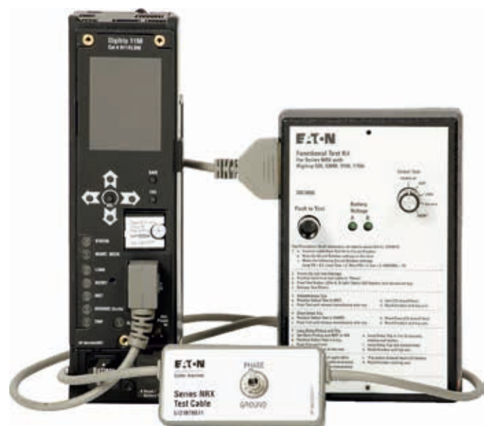
Slika 2 – Test kit z zaščitnim modulom odklopnika IZMX
