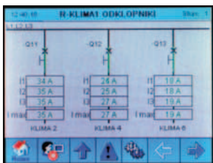
Sliki 8 in 9 – Prikaz stanja stikalnega bloka za napajanje hladilnih naprav na lokalnem panelu in na CNS-u
