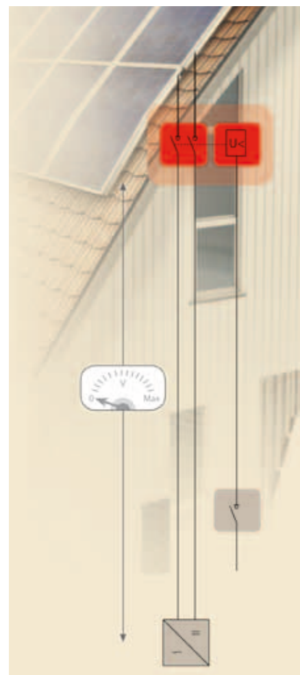
Slika 2 – Ločevanje tokokroga DC fotonapetostne elektrarne
