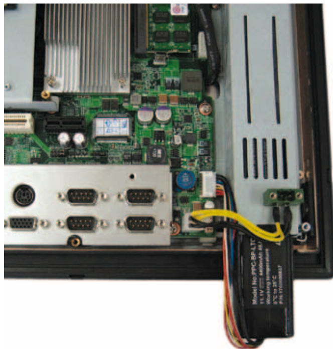
Slika 5 – Priključitev baterijskega modula
