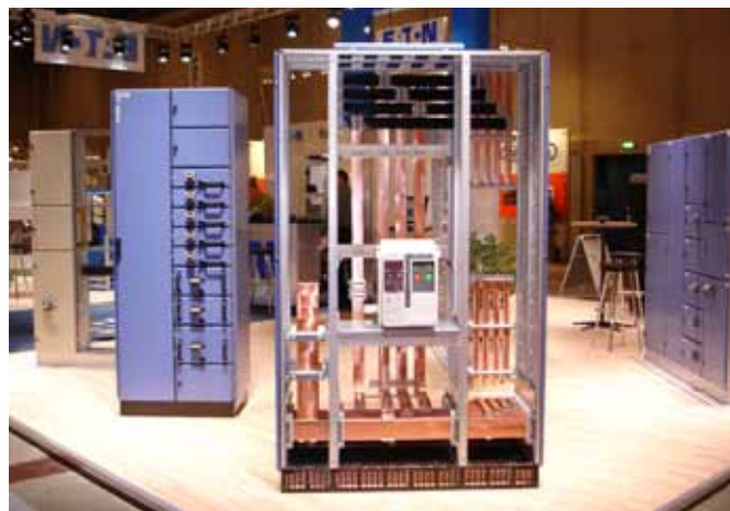
Slika 1 – Stikalni bloki TABULA so lahko konstruirani v fiksni, vtični ali izvlečljivi izvedbi, s stopnjo notranje delitve do 4B, z nazivnim tokom do 7800 A, z nazivno napetostjo do 1000 V in mehansko zaščito do IP54
