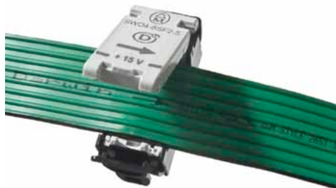
Slika 4 – Zeleni osempolni kabel je življenjska žila SmartWire-Darwin sistema
