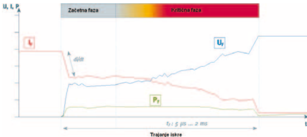
Slika 2 – Pojav iskre - dinamični potek toka I_r , napetosti U_f in moči P_f
