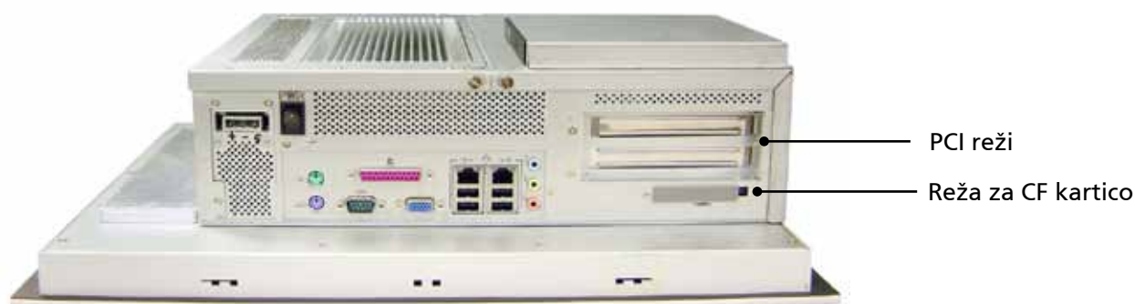
Slika 4 - IPPC-6152F in IPPC-6172F nam z dvema PCI-režama omogočata različne rešitve in prilagajanje računalnika različnim potrebam vsakega posameznika
